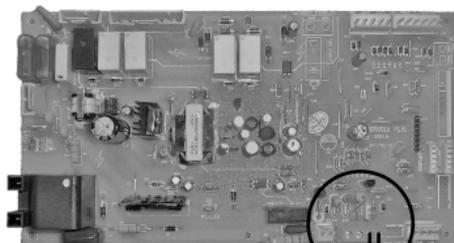
4. Проложите кабель от датчика к плате электроники котла, зачистите концы и зажмите в двух крайних правых винтовых зажимах клемной колодки CN10 зеленого цвета с обозначением «**Outside Temp**» как показано на рисунке, после чего установите обратно кожух платы, панель и облицовку котла. Перемычка на соседних зажимах должна оставаться, если только вместо нее не подсоединен комнатный термостат.
