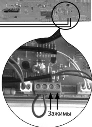
После монтажа датчика электроника котла опознает его и автоматически перейдет в режим управления по наружной температуре, дальнейшие настройки на стороне котла см. в соотв. руководствах к котлу.
